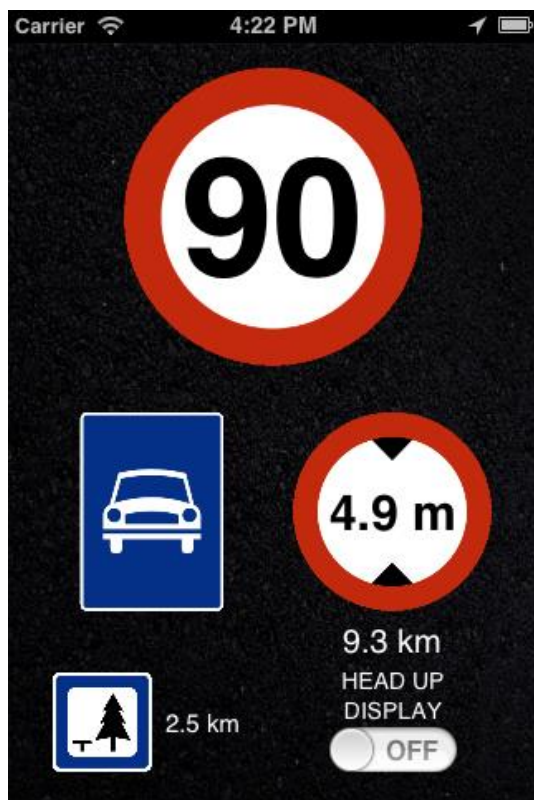
Figur 21: Et skjermbilde av applikasjonen i bruk. På en 3,5" skjerm er det kun plass til fire skilt når HUD-knappen vises.
