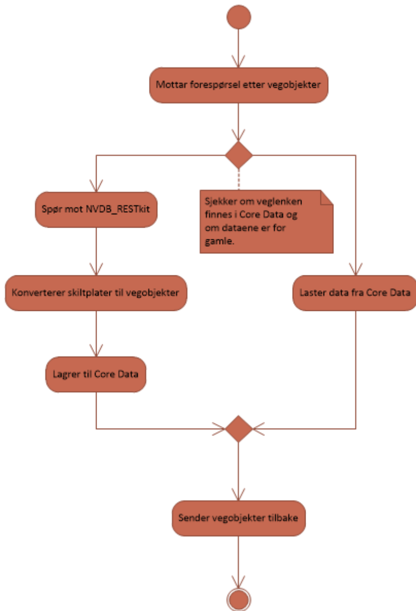
Figur 17: Aktivitetsdiagrammet viser hva NVDB_DataProvider gjør når den mottar en forespørsel etter vegobjekter.
